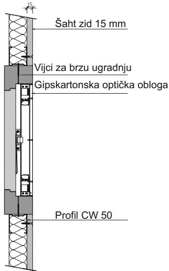
Revizioni otvor FireRev basic F90 u šaht zidu F90
