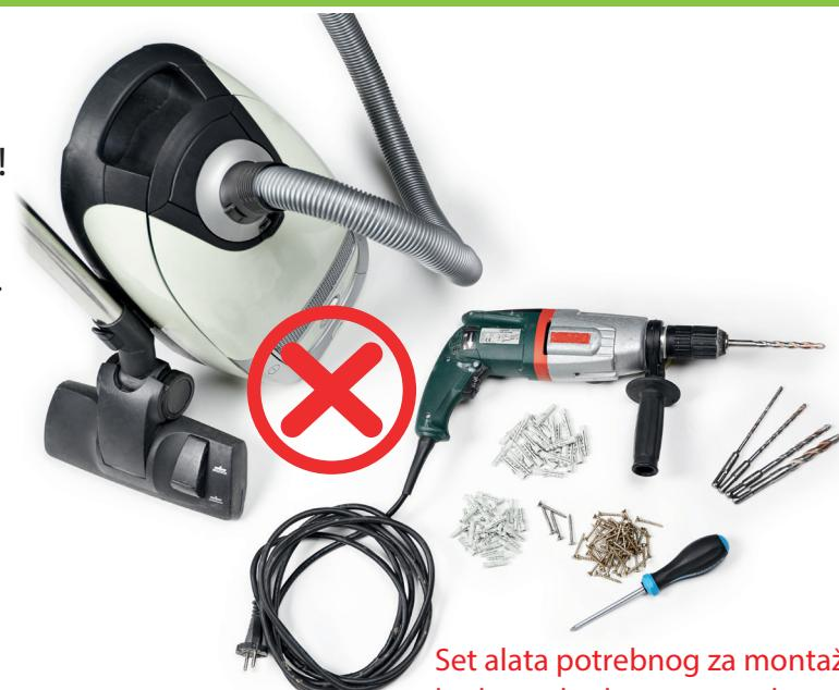
Set alata potrebnog za montažu kod standardnog pregradnog zida.
