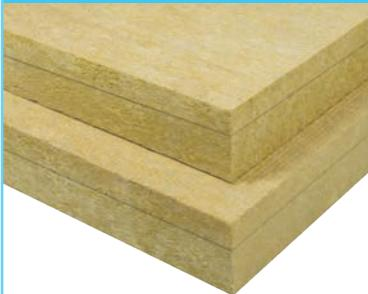
**SmartRoof Base 2** je kompaktna ploča od kamene mineralne vune, dvoslojne gustine i spada u jako tvrde proizvode. Proizvod je negoriv, otporan na visoke temperature, vodoodbojan, otporan na starenje i hemijski neutralan. Dimenzije se ne menjaju usled velikih temperaturnih promena.
