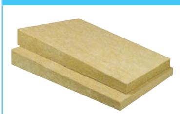
**SmartRoof Top CTF 2** klinovi sa dve kosine su zakošene ploče od kamene vune velike gustine i spadaju u jako tvrde proizvode. Proizvod je negoriv, otporan na visoke temperature, vodoodbojan i otporan na starenje i hemijski neutralan. Dimenzije se ne menjaju usled temperaturnih promena.
