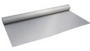
**Homeseal LDS 200 AluPlus** je visoko paroodbojna parna brana sa reflektujućim aluminiziranim slojem na polietilenскоj foliji sa armaturnom mrežicom. Reflektujući sloj reflektuje toplotu nazad u unutrašnji prostor i na taj način štedi energiju.
