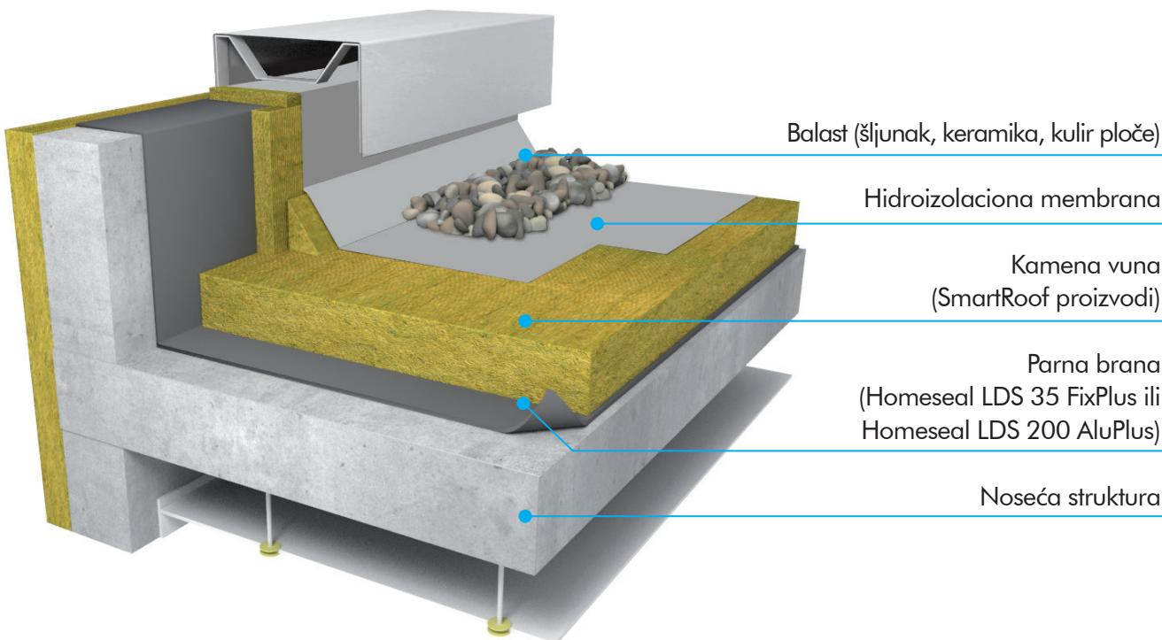
Slagani sistem sa kamenom vunom je idealan sistem za izolaciju ravnog prohodnog krova. Prednosti su: jednostavna i brza ugradnja, otpornost na požar, paropropustljivost, dimenzionalna stabilnost, povišena zvučna izolacija, mogućnost realizacije različitih varijanti obloge na prohodnoj krovnoj terasi.
