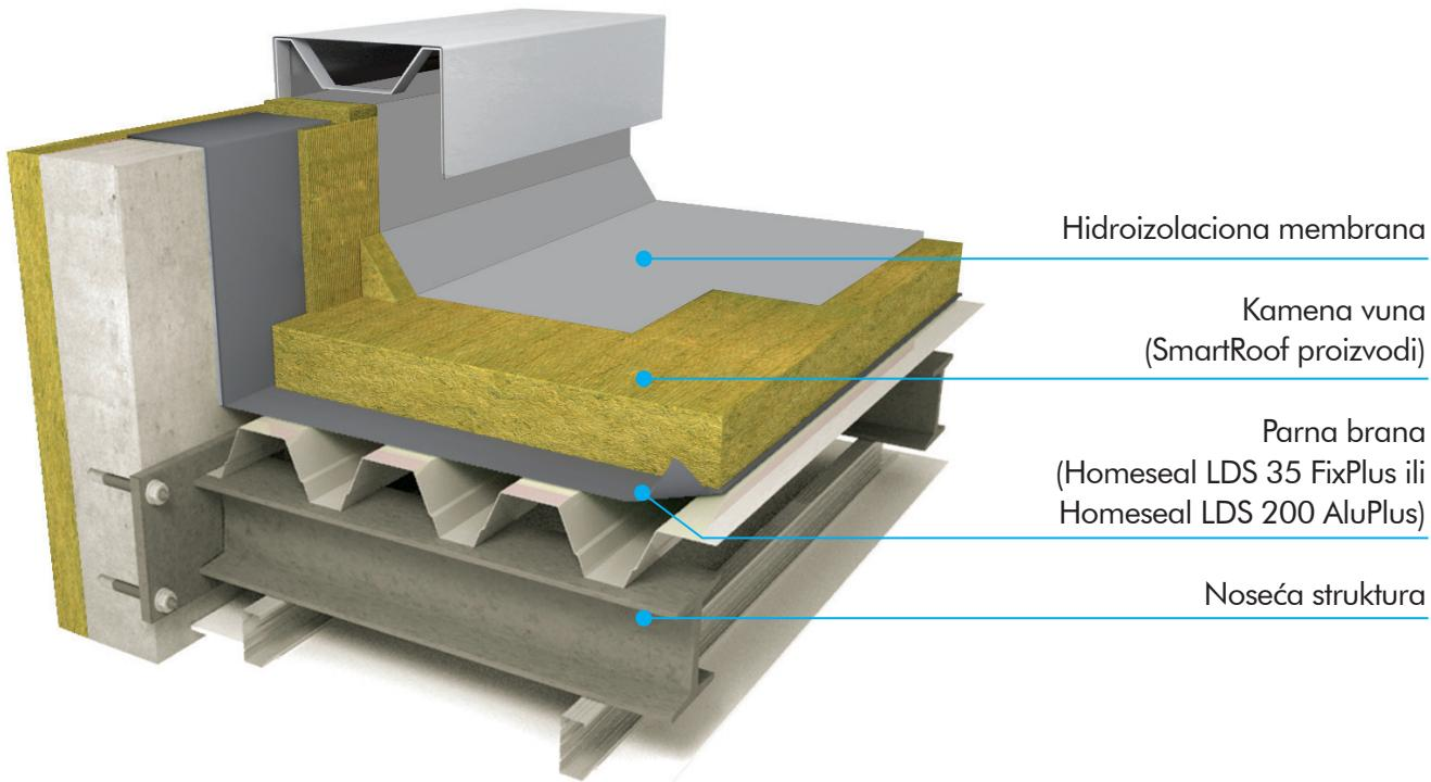
Slagani sistem sa kamenom vunom je idealan sistem za izolaciju ravnog neprohodnog krova. Prednosti su: jednostavna i brza ugradnja, otpornost na požar\*, paropropustljivost, dimenzionalna stabilnost, povišena zvučna izolacija.
