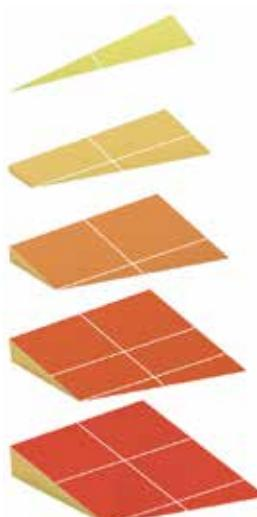
Sustav površinske odvodnje od PU blokova povećane gustoće. Setove je potrebno kombinirati da se dobije potpuni željeni sustav.
