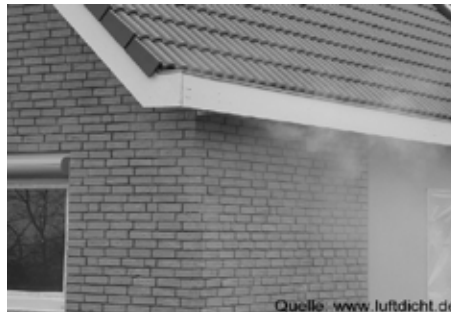
Blower-Door-Prüfverfahren Variante B: mit Überdruck und Nebel zur Leckagesuche
