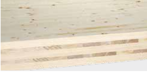
Geschlossene Holzbalkendecke, Einschub tragend 140 mm Brettsperholzdecke
